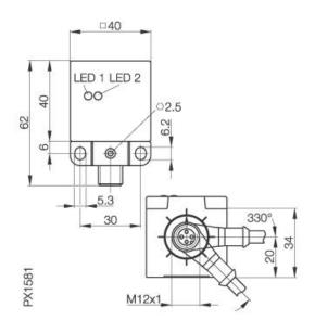
Induktiver Näherungsschalter BES Q40KFU-PSC30F-S04G 40 x 40 x 62 Schließer Sn=30mm nicht bündig einbaubar
